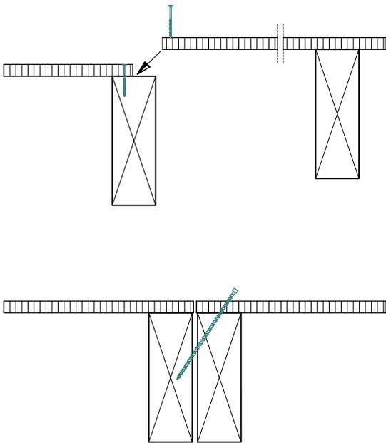
**Abb. 98:** Sinnvoll ist der Einsatz von breiteren Holzwerkstoffplatten (1,25 m) bei der Deckenbeplankung. Sodann kann der Balkenabstand bis 93 cm frei gewählt werden..
