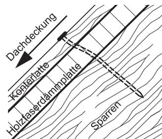
Das Bauteil Konterlatte übernimmt eine bedeutende statische Funktion. Die Anforderungen an die Holzgüte sind erhöht. Konterlatten aus Nadelholz sind in der Sortierklasse S 10 nach DIN 4074-1 zu wählen. Die Konterlatte unterscheidet sich in der Kennzeichnungspflicht nicht von der Dachlatte.
