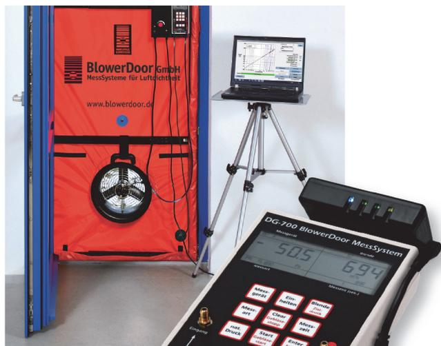
Für die Auftragnehmer hingegen ist eine Luftdichtheitsmessung im Zuge von Abnahmen wichtig. Der Messzeitpunkt wird dann durch die Gewerkegrenzen bestimmt. Die Luftdichtheitsebene muss fertiggestellt sein, d.h. Fenster, Dampfbremse/Luftdichtung im Dach etc., müssen eingebaut sein.
