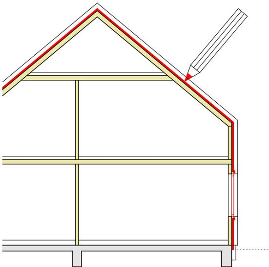
**Abb. 83:** Die Luftdichtungsbahn wird am Übergang zum Steildach in diesem Beispiel auf der Außenseite der Brettsperrholzelemente angeordnet.
