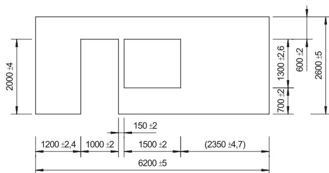
**Abb. 73:** Bestimmung der Rechtwinkligkeit bei einer Wandtafel.
