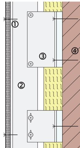
1. Fassadenbekleidung mit Befestigungselement (hier Nieten oder Schrauben)
