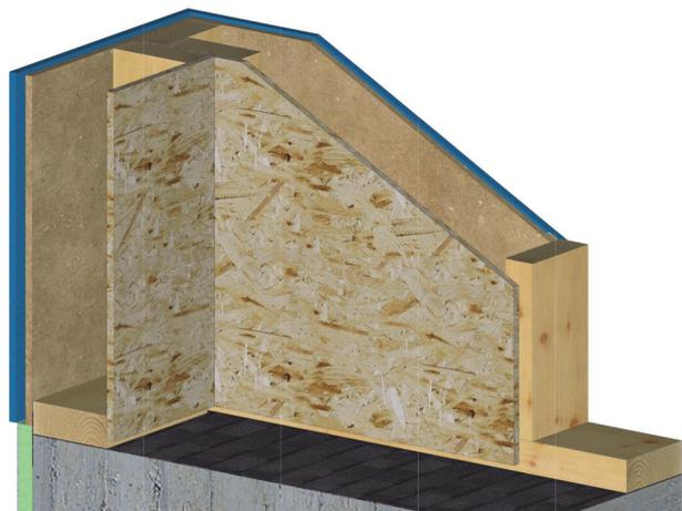
**Abb. 76:** Beim Holzmassivbau ist die massive, tragende Wandschale auf der Raumseite. Auf der Außenseite wird die Hauptdämmebene montiert. Dies hat viele Vorzüge.
