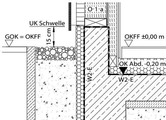
Soll das Geländeniveau auf Höhe Fertigfußboden liegen (OKFF), so bietet eine Betonaufkantung (Abb. 41) hinsichtlich des Holzschutzes eine sichere Lösung. Die vertikale Abdichtung kann normgerecht ausschließlich auf Beton oder Mauerwerk ausgeführt werden.
