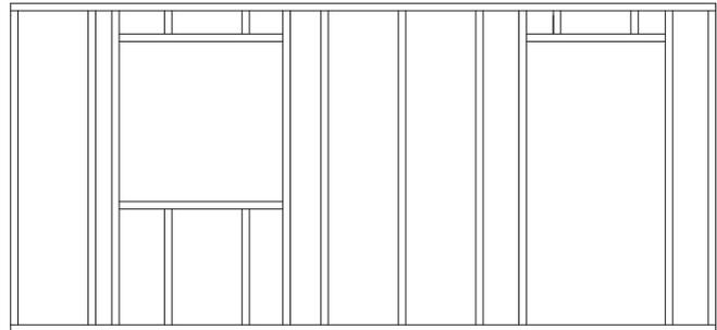
Bei den Nachweisverfahren nach GEG für den Wärmeschutz ist jedoch allein der U-Wert für den regelmäßigen Wandaufbau zu berechnen. Alle anderen Anschlussholzer werden im Rahmen der Wärmebrücken berücksichtigt. Der U-Wert bleibt bei diesem Beispiel bei  $0,18 \text{ W}/\text{m}^2\text{K}$ .
