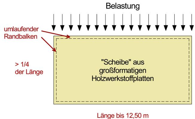
**Abb. 96:** Die Beplankungen laufen immer quer zu den Deckenbalken. Die Querstöße der Platten müssen (!) auf dem Balken liegen. Die Längsstöße haben eine Nut-Feder-Verbindung, eine Verleimung ist nicht erforderlich. Die Balken können im Gebäude längs oder quer gespannt werden.
