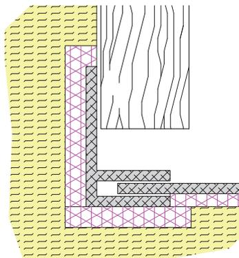
**Abb. 51:** Ein wasserdichter Anschluss ist mit einer zusätzliche Abdichtung unterhalb der Fensterbank realisierbar (siehe H • 6 • g).
