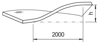
Abb. 118: Längskrümmung in Richtung der Dicke
