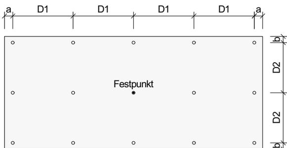
Zur zwängungsfreien Montage sind Fest- und Gleitpunkte auszubilden. Dabei dient der Festpunkt zur Aufnahme der Vertikallasten (Eigengewicht) und der gleichmäßigen Verteilung der Quell- und Schwindbewegungen. Die übrigen Befestigungen werden als Gleitpunkte ausgeführt. Über diese werden die horizontalen Lasten (Windlasten) abgetragen. Gleichzeitig wird die Bewegung der Kompaktplatten ermöglicht.
