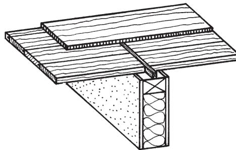
Sinnvoll ist es, die Oberflächenvergütung der sichtbaren Schalung bereits vor dem Einbau vorzunehmen. Maschinell aufgetragene Beschichtungen<sup>®</sup> ergeben eine hochwertige Oberfläche und werden kostengünstiger ausgeführt. Sichtbare Deckenbalken sollten immer einen Grundanstrich nach dem Abbund erhalten. Leichte Verschmutzungen aus der Montage können dann i. d. R. einfach abgewischt werden.
