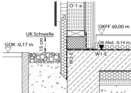
In Abb. 42 wird eine Lösung gezeigt, die einen geringen Höhenunterschied innen/außen von einer Stufe aufweist. Die Dämmung unterhalb der Sohlplatte reduziert die Höhe des Fußbodenaufbaus. Wichtige Bedingungen werden eingehalten:
