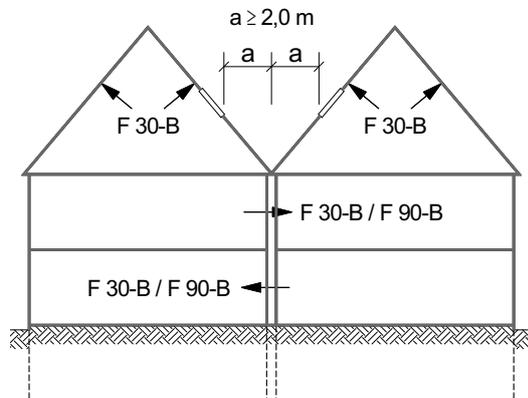
Steildächer, die eine Klassifizierung F 30-B erzielen, können mit einer Vollsparrendämmung ausgeführt werden, die mindestens normalentflammbar ist. Hohlraumdämmstoffe aus Naturfaser (z. B. Holzfaser, Hanf oder Zellulose-Einblasdämmung) sind möglich. Voraussetzung ist die Ausführung der Beplankung bzw. Bekleidung nach Tab. 54. Dann bestehen an die Dämmschicht brandschutztechnisch keine besonderen Anforderungen.
