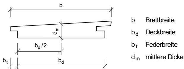
Bei Profilbrett-, Stülp- oder Deckelschalungen werden die Bretter zusätzlich zu den Befestigungsmitteln durch andere Fassadenbretter gehalten. Daher ist bei einer Deckbreite bis 120 mm ein Befestigungsmittel je Befestigungspunkt ausreichend (Abb. 55, oben). Ab einer Brettbreite von mehr als 120 mm sind zwei Befestigungen erforderlich (Abb. 55 unten).
