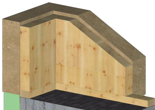
**Abb. 77:** Blick in eine Gebäudeecke bei der verschiedene Bauarten kombiniert wurden (Beispiel). Das Zusammenspiel funktioniert, wenn die Vorteile der verschiedenen Bauarten jeweils ausgenutzt werden. Der Wechsel an der Geschossdecke kann sehr interessant und leistungsfähig sein.
