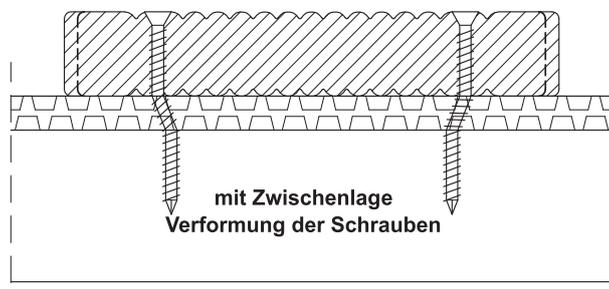
Die Zwischenlage vermeidet den Abriss der Schrauben durch Verformung, sowie eine Kapillarfuge zwischen Unterkonstruktion und Dielenbelag. Eine Auffeuchtung wird erheblich reduziert.
