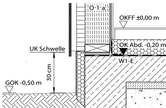
**Abb. 39:** Bewährte Sockelhöhe im Holzbau ( $\geq 15$  cm). Die Geländeoberkante GOK liegt auf -0,35 m. Das bedeutet einen Höhenversatz zum Außenbereich von mindestens zwei Stufen. Zur Reduzierung der Spritzwasserbeanspruchung ist ein Kiesstreifen erforderlich; Breite 30 cm von Außenkante Schwelle, Korngröße 16/32 mm. Die Fuge zwischen Beton und Holzkonstruktion kann mit einer diffusionsoffenen Schleppbahn (z. B. Fassadenbahn) oder einem Klebeband zusätzlich vor Feuchtigkeit geschützt werden.
