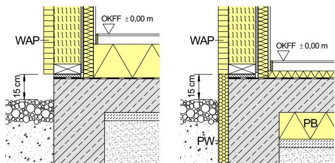
**Abb. 46:** Ausführung eines Sockelputzes ① mit Putzabdichtung ② und Noppenbahn ③ als Schutzschicht. Die Putzabdichtung ② ist mindestens 50 mm über Geländeoberkante (GOK) zu führen. Bei Treppen sind es 80 mm.
